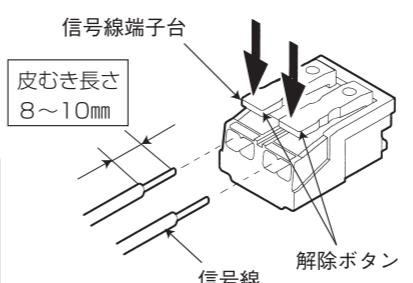
○信号端子台に接続された信号線を取り外すときは、解除ボタンを押す。
