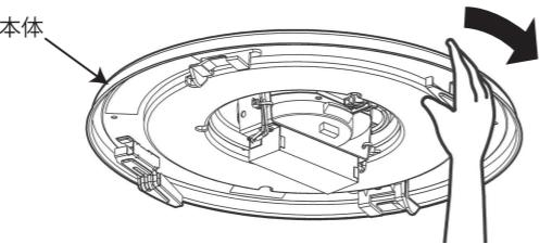
**注意** ボタンを押さずに回すと配線器具が破損します。
