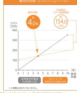
【比較条件】●室空間:間口21.6m×奥行10.8m×天高2.7m ●反射率:天井70%、壁50%、床10% ●計算面高さ:机上面(床上0.7m) ●年間点灯時間:3,000時間 ●電力料金目安単価:27円/kWh(税込)[平成26年4月改定]
