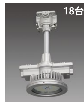
防爆形LED照明器具 高天井形 パイプ吊形 DRPE13H01(TB)S/N-PJ8 平均消費電力: 92W
