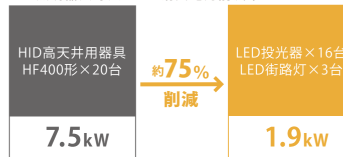
LED照明器具導入による消費電力削減率
