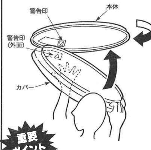
本体の警告印(△)にカバーの警告印(△)を合わせカバーを持ち上げパチンと音がするまでカバーを右にまわしてください。
