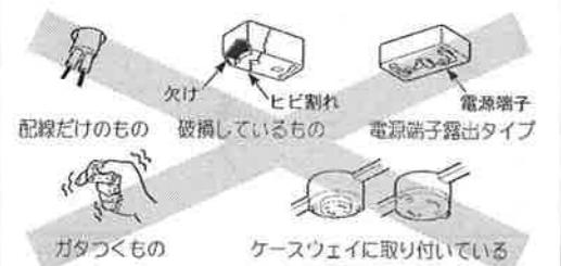
取り付ける際は、必ず上図の取り付け可能な引掛シーリングに交換して下さい。
