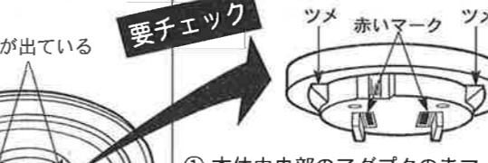
①本体中央部のアダプタの赤マーク(2ヶ所)が完全に見え、アダプタのツメ(2ヶ所)が完全に出ていることを確認する。
