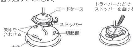
必ず回り止め用のストッパーを本体の穴に曲げ込んでください。コードケースを左に回して外れないことを確認してください。
