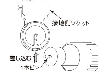
(3) 給電側(ランプ2本ピン)を取付ける。
