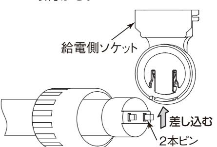
(4) ランプピンをソケットの根本まで「カチッ」と音がするまで差し込んだ後、キャップを左右均等に締めつける。
