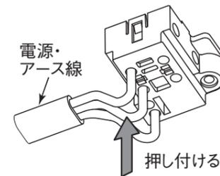
○電源線接続の速結端子の電源線を取り外すときは、幅6mmのマイナスドライバーを、はずし穴にまっすぐに差し込んでください。
