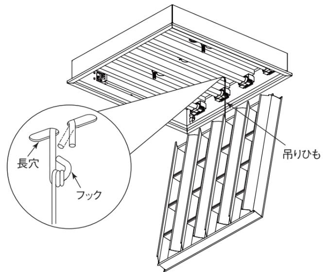
(2) 吊りひも側 (ソケット側) を器具本体に押し込み、下図のように回転させる。吊りひもを、ルーバのV形反射板の中に収納して、ルーバ保持バネが、ルーバを支えるまで押し込む。
