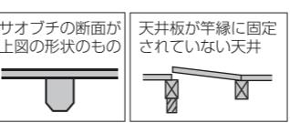
NEC製LEDシーリングライトは、別売りの竿縁・傾斜天井用アダプタ(699-8492)を使用していただくことで竿縁天井や傾斜天井に取り付けることができます。
