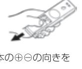
2. 単3形マンガン電池(推奨)2本の+/-の向きを合わせて挿入する。
