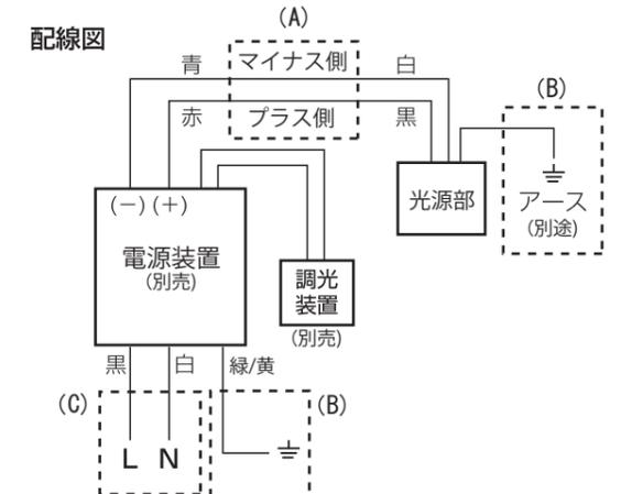
※調光信号が入力されると、初期照度補正機能は解除されますが連続点灯時間はカウントを続けます。
