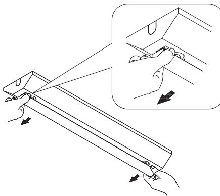
(2) スライドにより空いた隙間にマイナスドライバーなどを差し込みライト棒を矢印の方向に引き下げ爪をはずしていくとライト棒が外れます。
