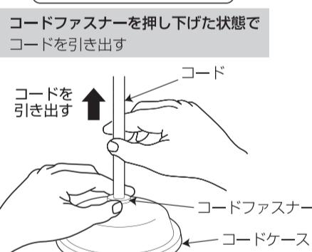
②コードの長さを調節したらコードファスナーを引き上げてコードを固定させてください。
