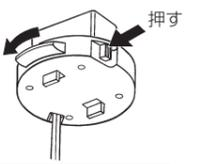
**注意事項** ボタンを押さずに回すと配線器具が破損します。
