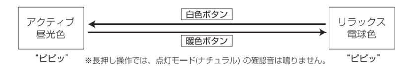
■短押しすると1段階ずつ点灯モード(色)が切り替わります。(確認音が鳴ります。)
