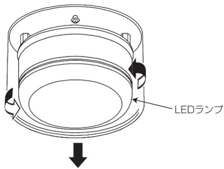
②取付ネジ(2本)を緩めて、ソケット取付金具を左に回して取り外してください。
