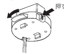
**注意事項** ボタンを押さずに回すと配線器具が破損します。
