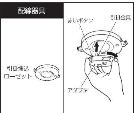
**要チェック** 取り付け後、赤いボタンを押さずに左(反時計回り)に回して、はずれないことを確認してください。
